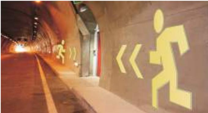
A instalação destes sinais permite uma perfeita identificação das saídas de emergência a uma distância elevada evitando, assim, situações de pânico.
