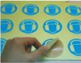
Sinais para a identificação de uso de EPI, alerta de riscos ou proibições referentes a cada equipamento. É a sinalização ideal porque fica instalada onde é mais visível pelo operador - no próprio equipamento. Se for possível, instalar perto do botão de "ligar/ desligar".
