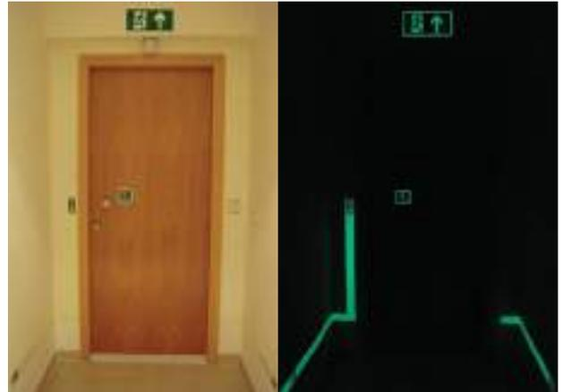
Sinais em PVC para instalar entre os perfis de PVC da pág. 79. Sinais para instalar de modo a que o topo dos sinais e do perfil fiquem a 0,4m do pavimento.
